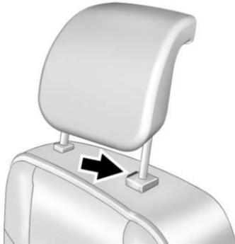
L'appui-tête de siège de la troisième rangée peut être abaissé afin d'avoir une meilleure visibilité lorsque le siège arrière n'est pas occupé.
