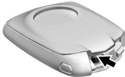
2. Séparer les deux moitiés de l'émetteur à l'aide d'un outil plat inséré au centre du bas de l'émetteur. Ne pas se servir de la fente de clé.
