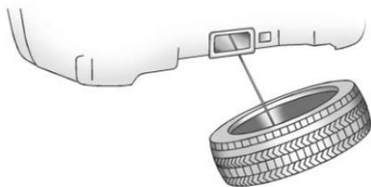
7. Pencher le pneu vers le véhicule avec un relâchement dans le câble afin d'accéder à la retenue
