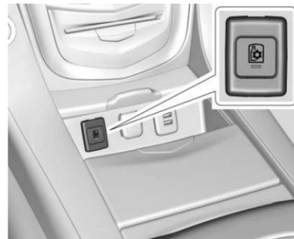
Selon l'équipement, appuyer pour activer le compartiment refroidi à l'intérieur du rangement de console centrale.
