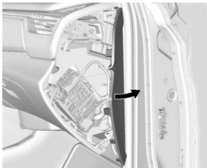
Le volet d'accès à la boîte à fusibles du tableau de bord droit se trouve sur le bord du tableau de bord, côté passager.
