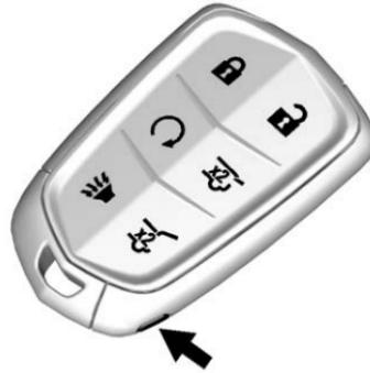
L'émetteur est doté d'un bouton sur le côté utilisé pour retirer la clé. Ne pas tirer sur la clé pour la faire sortir sans appuyer sur le bouton.
