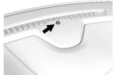
Le véhicule est doté d'un capteur de lumière se trouvant sur le haut du tableau de bord qui commande le système d'éclairage automatique. Ne pas recouvrir le capteur, sinon, les phares peuvent s'allumer quand ils ne sont pas nécessaires.
