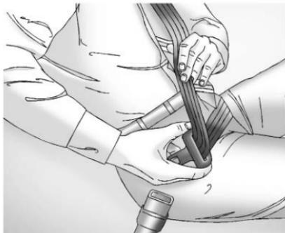
Pour les positions d'assise avant, si la sangle se bloque dans la plaque de verrouillage avant d'atteindre la boucle, incliner le verrou plat à l'horizontale pour déverrouiller.
