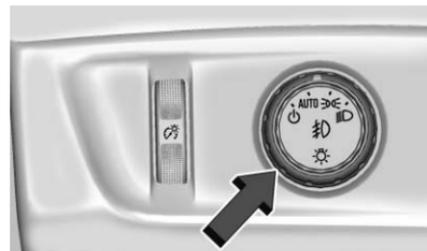
La commande d'éclairage extérieur se situe sur le tableau de bord, à gauche du volant de direction.
