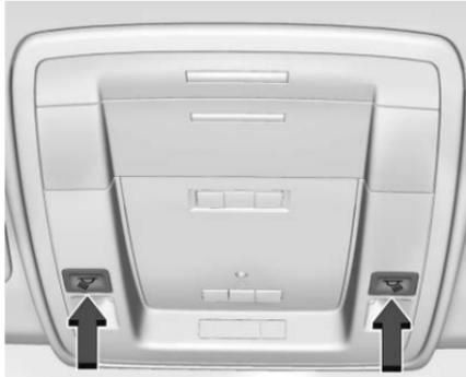
Le vide-poches de pavillon et le garnissage de pavillon sont dotés de lampes de lecture (selon l'équipement). Pour fonctionner, le commutateur d'allumage doit être activé ou sur ACC/ACCESSORY (accessoire), ou utiliser l'alimentation prolongée des accessoires (RAP).
