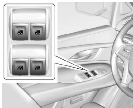
Les lève-vitres électriques fonctionnent lorsque le commutateur est en position contact ou ACC/ACCESSORY (accessoires) ou lorsque la prolongation de l'alimentation des accessoires (RAP) est active. Consulter *Alimentation accessoires conservée* ⇨ 233.
