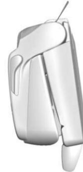
3. Lever ce même levier à nouveau pour libérer l'arrière du siège du plancher. Le siège se rabattra vers l'avant.
