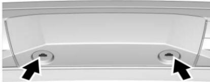
Si le véhicule est doté d'un cache d'attelage, tourner les dispositifs de maintien du cache d'attelage dans le sens inverse des aiguilles d'une montre et tirer le cache vers le bas pour le déposer avant de déposer la porte d'accès au treuil.
