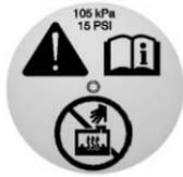
1. Déposer le bouchon de pression du vase d'expansion de liquide de refroidissement lorsque le système de refroidissement, y compris le bouchon de pression du vase d'expansion de liquide de refroidissement et le flexible supérieur du radiateur, n'est plus chaud.
