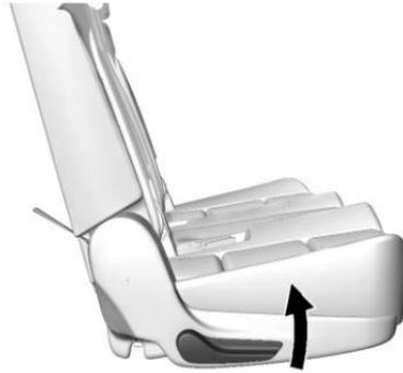
2. Lever le levier sur le côté extérieur du siège pour débloquer le dossier.
