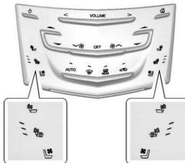
Les boutons sont proches des commandes de climatisation de l'empilement central. Pour les utiliser, le moteur doit tourner.
