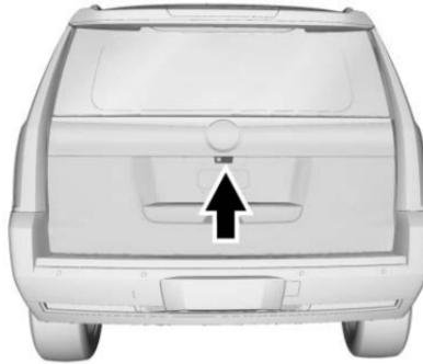
La caméra fournissant l'image de rétroviseur de caméra (RCM) arrière est située au-dessus de la plaque d'immatriculation, près de la caméra arrière (RVC).
