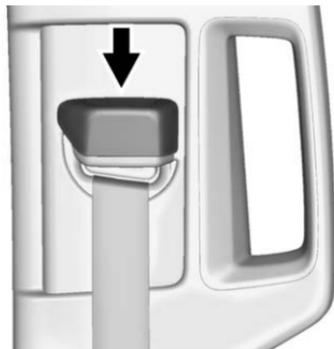
Enfoncer le bouton de déverrouillage pour déplacer le dispositif de réglage en hauteur à la position souhaitée.
