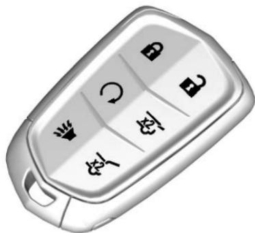
**🔑** : Si le véhicule en est équipé, appuyer et relâcher **🔑**, puis immédiatement appuyer et maintenir enfoncé **🔑** jusqu'à ce que les clignotants clignotent pendant au moins quatre secondes. Le moteur peut être
