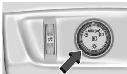
La commande de feux extérieurs se situe sur le tableau de bord sur la gauche du volant.
