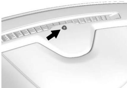
Le capteur solaire, situé au sommet du tableau de bord, près du pare-brise, mesure la chaleur solaire.
