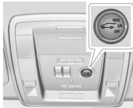
Le commutateur se trouve sur le vide-poches de pavillon. Le véhicule doit être en position de stationnement (P).
