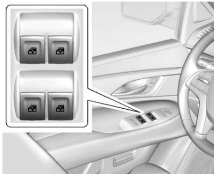
Les lève-vitres électriques fonctionnent lorsque le commutateur d'allumage est en position contact ou ACC/ACCESSORY (accessoires), ou quand le mode de prolongation de l'alimentation des accessoires (RAP) est actif. Se reporter à *Alimentation accessoires conservée* ⇨ 233.
