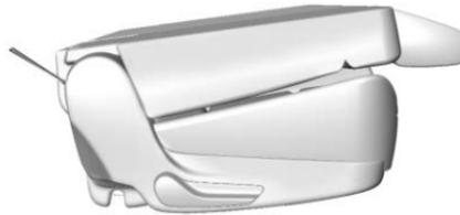
Le dossier de siège se repliera vers l'avant pour former un plancher de rechargement plat.
