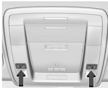
Le vide-poches de pavillon et le garnissage de pavillon sont dotés de lampes de lecture (selon l'équipement). Pour fonctionner, le contacteur d'allumage doit être activé ou sur ACC/ACCESSORY (accessoire) ou lorsque l'alimentation prolongée des accessoires (RAP) est utilisée.
