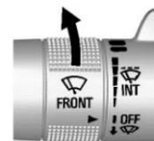
**INT** : Utiliser ce réglage pour les balayages intermittents ou Rainsense<sup>MC</sup>. Pour les balayages intermittents, tourner la bague FRONT vers le
