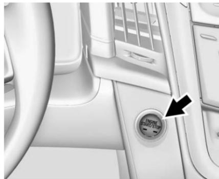
Le véhicule est équipé de l'accès sans clé et du démarrage par bouton-poussoir.
