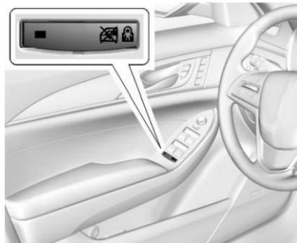
Cette fonction arrête le fonctionnement des commutateurs des vitres des passagers arrière.
