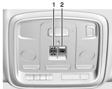
Le commutateur côté conducteur (1) actionne le toit ouvrant.
