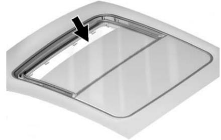
De la saleté et des débris peuvent s'accumuler sur le joint ou dans la glissière du toit ouvrant. Ceci peut causer un problème de fonctionnement ou de bruit du toit ouvrant. Le système d'écoulement d'eau peut également s'obstruer. Ouvrir périodiquement le toit ouvrant et retirer les obstacles ou les débris. Essuyer le joint du toit ouvrant et la zone d'étanchéité du toit avec un chiffon propre, du savon doux et de l'eau. Ne pas éliminer la graisse du toit ouvrant.
