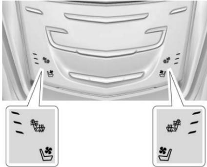
Selon l'équipement, les boutons se trouvent à côté des commandes de climatisation sur la console centrale. Le contact doit être mis.
