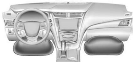
L'airbag de protection des genoux se trouve sous la colonne de direction. L'airbag de protection des genoux pour passager avant extérieur est sous la boîte à gants.
