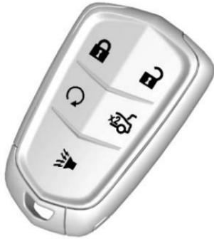
**🔒** : Appuyer pour verrouiller toutes les portes ainsi que la trappe à carburant. Les clignotants peuvent s'allumer et/ou l'avertisseur sonore peut retentir à la deuxième pression pour indiquer le verrouillage.
