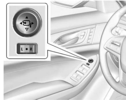
Les commandes pour les rétroviseurs électriques se situent sur la porte du conducteur.
