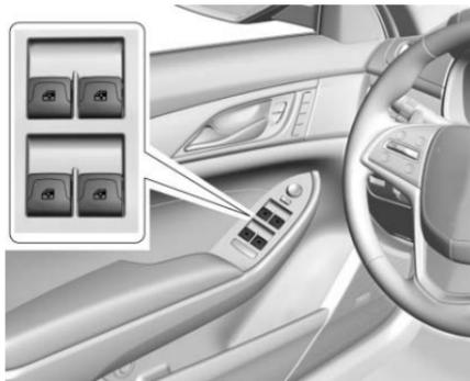
Les lève-vitres électriques fonctionnent lorsque le commutateur d'allumage est en position contact ou ACC/ACCESSORY (accessoires), ou quand le mode de prolongation de l'alimentation des accessoires (RAP) est actif. Se reporter à *Alimentation accessoires conservée* ⇨ 216.
