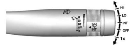
Avec le contact allumé ou en position ACC/ACCESSORY (accessoires), déplacer le levier d'essuie-glaces pour sélectionner la vitesse de balayage.
