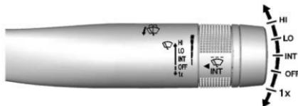
Lorsque le contact est activé ou sur ACC/ACCESSORY (accessoires), déplacer le levier pour sélectionner la vitesse de balayage.
