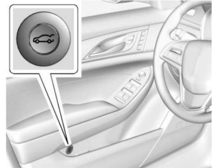
Pour ouvrir le coffre, le contact doit être coupé ou le levier de changement de vitesses doit être sur la position P (stationnement).
