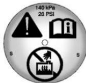
1. Retirer le bouchon de pression du vase d'expansion de liquide de refroidissement de la chambre supérieure lorsque le système de refroidissement, y compris le bouchon de pression du vase d'expansion de liquide de refroidissement et le flexible supérieur du radiateur, n'est plus chaud.
