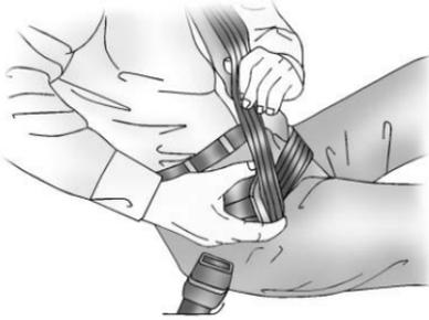
Si la sangle se bloque dans la plaque de verrouillage avant d'atteindre la boucle, incliner la plaque de verrouillage à plat pour déverrouiller.
