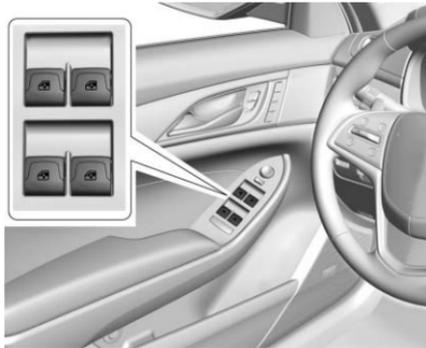
Les lève-vitres électriques fonctionnent lorsque le commutateur est en position contact ou ACC/ACCESSORY (accessoires) ou lorsque la prolongation de l'alimentation des accessoires (RAP) est active. Consulter *Alimentation accessoires conservée* ⇨ 216.
