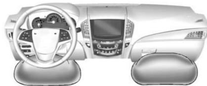
L'airbag de protection des genoux se trouve sous la colonne de direction. L'airbag de protection des genoux pour passager avant extérieur est sous la boîte à gants.
