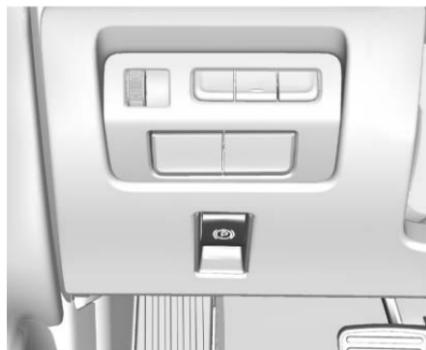
Selon l'équipement, le frein de stationnement électrique (EPB) peut toujours être activé, même si le contact est coupé. Pour éviter de décharger la batterie, éviter les cycles répétés du système de frein de stationnement électrique (EPB) quand le moteur ne tourne pas.
