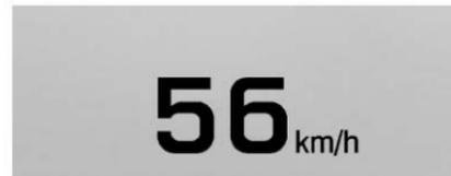
**Vue de la vitesse** : Cet affichage permet la lecture du compteur de vitesse (en unités anglaises ou métriques), du conseiller de panneaux routiers, de la vitesse du régulateur de vitesse adaptatif, de l'état d'alerte de collision avant, de l'avertisseur de franchissement de voie et de l'indicateur de véhicule devant. Certaines informations apparaissent uniquement sur les véhicules qui ont ces fonctions et lorsqu'elles sont activées.
