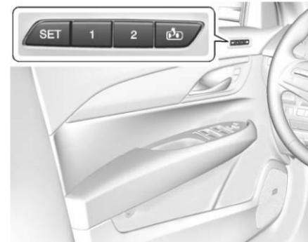
Sur les véhicules équipés, les sièges à mémoire permettent à deux conducteurs de mémoriser et rappeler chacun leur position de conduite et une position de sortie commune pour quitter le véhicule. Les positions d'autres équipements peuvent aussi être mémorisées, comme les rétroviseurs et le volant à réglage électrique, selon l'équipement. Les positions mémorisées sont reliées à l'émetteur RKE 1 ou 2 pour les rappels automatiques.
