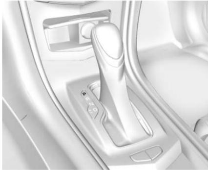
**P :** Cette position bloque les roues motrices. Utiliser la position P (stationnement) en démarrant le moteur, car elle limite le déplacement du véhicule.
