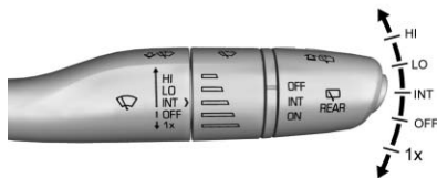
Essuie-glace à balayage intermittent (INT illustré)
