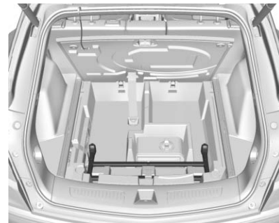
Véhicule avec nécessaire de gonflage de pneu
