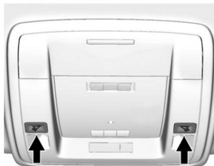
Le vide-poches de pavillon et le garnissage de pavillon sont dotés de lampes de lecture (selon l'équipement). Pour qu'elles puissent s'allumer, le contact doit être tourné sur la position ACC/ACCESSORY (accessoires) ou ON/RUN (En fonction/marche) ou le système de prolongation de l'alimentation des accessoires (RAP) doit être utilisé.
