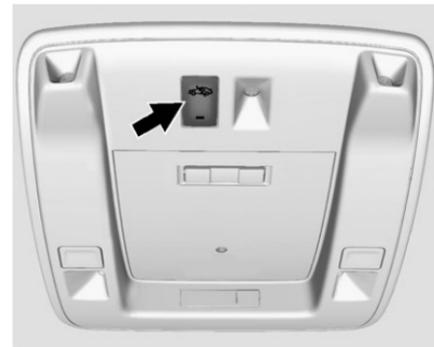
Il est recommandé de désactiver les capteurs d'intrusion et d'inclinaison si des animaux domestiques sont abandonnés dans le véhicule ou si le véhicule est transporté.
