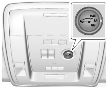
Le commutateur (si le véhicule est équipé de l'option) se trouve sur le vide-poches de pavillon. Le véhicule doit être en position de stationnement (P).
