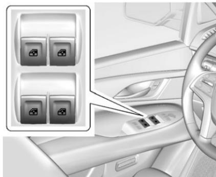
Les lève-vitres électriques fonctionnent lorsque le commutateur d'allumage est en position ON/RUN (en fonction/marche) ou ACC/ACCESSORY (accessoires) ou en mode de prolongation de l'alimentation des accessoires (RAP). Enfoncer le commutateur pour abaisser la vitre. Tirer le commutateur pour la remonter. Consulter *Système de prolongation de l'alimentation des accessoires (RAP)* ⇨ 236.
