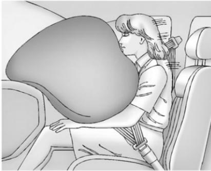
L'airbag frontal du passager extérieur avant se trouve dans le tableau de bord côté passager.
