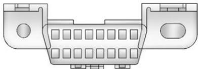
Le DLC se trouve sous le tableau de bord, à gauche du volant. Le branchement d'appareils n'étant pas utilisés pour effectuer un test d'inspection/maintenance des émissions ou pour une intervention sur le véhicule peut nuire au fonctionnement du véhicule. Voir *Ajout d'un équipement électrique* ↗ 299. Consulter le réparateur agréé si une assistance s'avère nécessaire.
