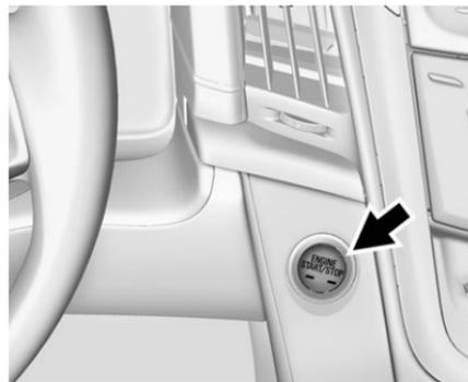
Les véhicules dotés d'un système d'accès sans clé sont équipés d'un démarrage par bouton-poussoir.
