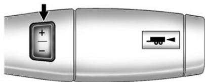
Si le véhicule en est équipé, le mode de sélection de gamme facilite le contrôle de la boîte de
