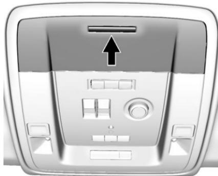
Si le véhicule en est équipé, un rangement pour lunettes de soleil est disponible sur le vide-poches de pavillon. Appuyer sur le bouton fixe du volet et relâcher pour avoir accès. Un rétroviseur de surveillance enfant peut être positionné dans le compartiment de rangement pour lunettes de soleil. Relâcher le rangement, puis rentrer le rangement à mi-course pour le fixer en position.
