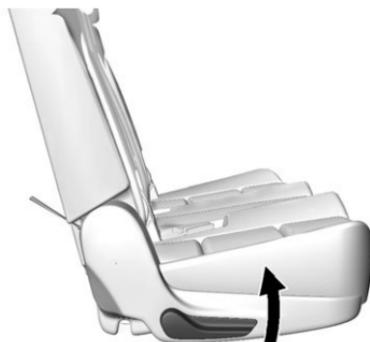
1. Lever le levier qui se trouve du côté extérieur du siège.
