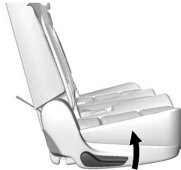
2. Lever le levier sur le côté extérieur du siège pour débloquer le dossier.
