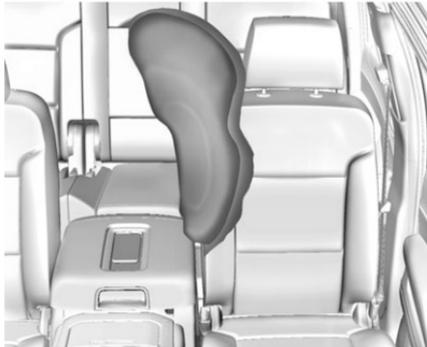
L'airbag central avant se trouve du côté intérieur du dossier de siège du conducteur.
