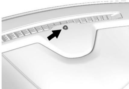
Le véhicule est doté d'un capteur de lumière se trouvant sur le haut du tableau de bord qui commande le système d'éclairage automatique. Ne pas recouvrir le capteur, sinon, les phares peuvent s'allumer quand ils ne sont pas nécessaires.
