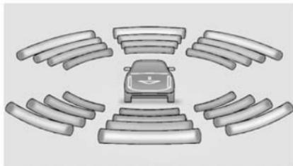
Le véhicule peut être équipé d'un écran d'aide au stationnement de combiné d'instruments avec des barres qui montrent la distance par rapport à l'objet et la localisation de l'objet pour la fonction URPA et sur certains véhicules, pour le système d'aide au stationnement avant. Lorsque l'objet se rapproche, d'autres barres s'allument et les
