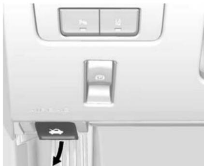
1. Tirer la poignée de déverrouillage du capot à l'intérieur du véhicule. Elle se trouve sur le côté gauche du tableau de bord.
