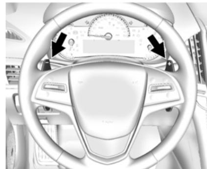
Si le véhicule en est équipé, les commandes de changement de rapport à impulsions se trouvent à l'arrière du volant.
