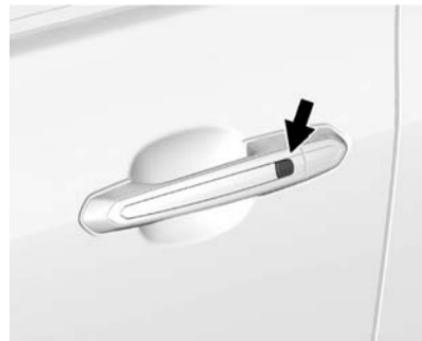
Si le véhicule en est équipé, utiliser le système d'accès sans clé pour verrouiller et déverrouiller la porte. Lorsque les portes sont verrouillées et que l'émetteur d'accès à distance sans clé se trouve dans un rayon de
