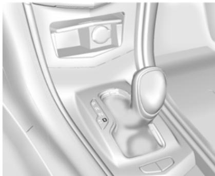
Les véhicules avec DSC peuvent utiliser le levier de vitesse ou les commandes de sélection par impulsion à l'arrière du volant (selon l'équipement), pour les changements de rapport manuels de la boîte de vitesses automatique.
