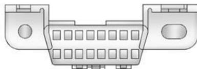
Le DLC se trouve sous le tableau de bord, à gauche du volant. Consulter le réparateur agréé si une assistance s'avère nécessaire.
