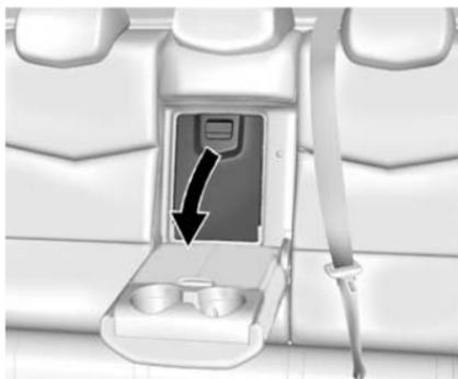
Il existe une trappe de traversée de siège arrière au centre du dossier de siège arrière. Abaisser l'accoudeur central et tirer sur le loquet pour ouvrir la trappe.
