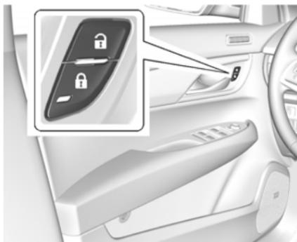
**🔒 (verrouillage):** Presser pour verrouiller les portes. Le témoin du commutateur s'allume lorsqu'il est activé.
