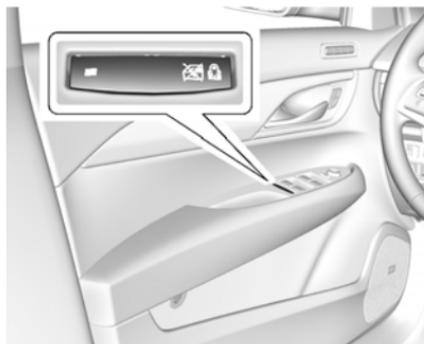
Ce dispositif empêche le fonctionnement des vitres passagers arrière, sauf pour le conducteur.
