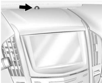
Un capteur de lumière est sur le haut du tableau de bord. Ne pas recouvrir le capteur, sinon, les phares s'allument quand ils ne sont pas nécessaires.
