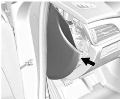
Pour accéder aux fusibles, déposer le panneau d'extrémité en faisant légèrement lever avec un outil en plastique près de chaque collier, en commençant par le point indiqué.
