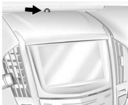
Le capteur solaire surveille le chauffage solaire.
