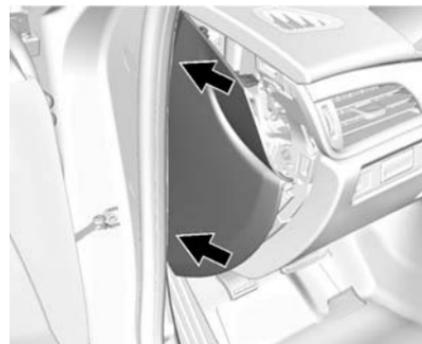
Pour poser le couvercle d'extrémité, introduire les pattes à l'arrière du couvercle dans les fentes du tableau de bord, au niveau des points indiqués. Aligner le colliers avec les fentes dans le tableau de bord et appuyer sur le couvercle.
