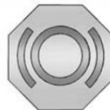
Le bouchon du réservoir de liquide de frein/embrayage hydraulique a soit un symbole soit un texte précisant le type de liquide de frein. Le réservoir commun de liquide de frein/embrayage est rempli de liquide de frein DOT 3 approuvé par GM, comme indiqué sur le bouchon du réservoir. Consulter *Vue d'ensemble du compartiment moteur* à la page 10-5 pour connaître l'emplacement du réservoir.
