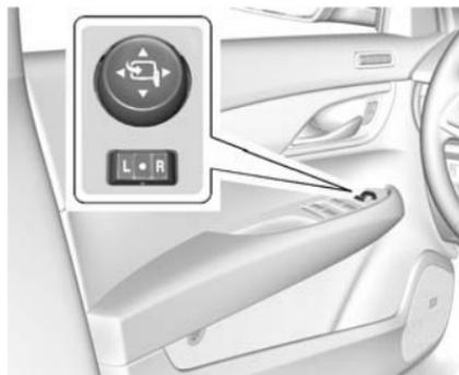
1. Déplacer le sélecteur sur L (gauche) ou R (droite) pour choisir le rétroviseur du côté conducteur ou du côté passager.
