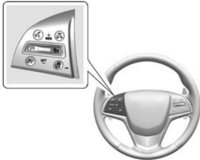
**MARCHÉ/ARRÊT**: Appuyer sur ce bouton pour mettre le système en fonction ou hors fonction. Un témoin blanc de régulateur de vitesse s'allume.
