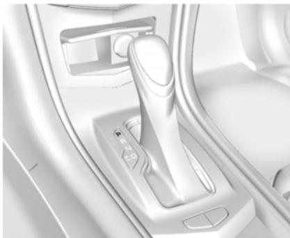
**P (stationnement):** Cette position bloque les roues arrière. Utiliser cette position en démarrant le moteur, car elle limite le déplacement du véhicule.
