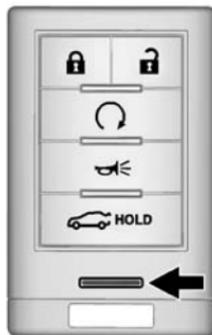
Pour la retirer, presser le bouton situé en bas de l'émetteur et retirer la clé. Ne jamais pas extraire la clé sans appuyer sur le bouton.
