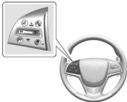
**⏸ (marche/arrêt):** Appuyer pour mettre le système en/hors fonction. Un témoin blanc du régulateur de vitesse s'affiche au combiné d'instruments lorsque le régulateur de vitesse est tourné en position de marche.
