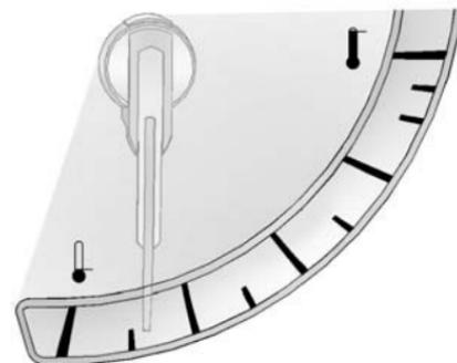
Cette jauge mesure la température du moteur du véhicule.
