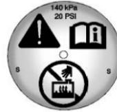
1. Tourner lentement le bouchon à surpression dans le sens antihoraire. Si un sifflement se fait entendre, attendre qu'il s'arrête. Un sifflement indique qu'une pression résiduelle est toujours présente.
