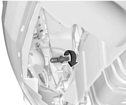
4. Tourner la douille de l'ampoule dans le sens inverse des aiguilles d'une montre et extraire l'ampoule de la douille.
