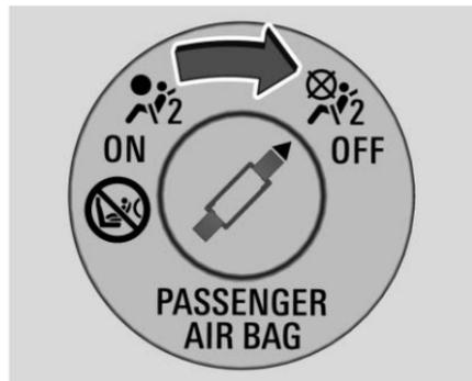
Pour désactiver l'airbag frontal de passager avant extérieur, introduire la clé de contact dans l'interrupteur marche-arrêt d'airbag, l'enfoncer, et tourner le commutateur en position OFF (désactivation).
