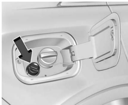
Le bouchon d'AdBlue bleu se trouve derrière la trappe à carburant/AdBlue. Si le véhicule est équipé d'un bouchon de carburant, ne pas retirer les bouchons de carburant et d'AdBlue en même temps. Remplir le carburant diesel et l'AdBlue de manière indépendante. Tourner le bouchon d'AdBlue dans le sens anti-horaire pour le retirer.
