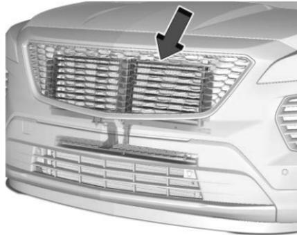
Le véhicule peut être équipé d'un système d'obturation conçu pour améliorer l'économie de carburant. Veiller à ce que le système d'obturation soit exempt de débris, de neige et de glace. Si le voyant de contrôle du moteur est activé, prière vérifier si le système d'obturation est exempt de débris, de neige ou de glace.
