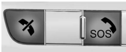
Le système eCall peut également être activé manuellement. Presser **SOS** sur la console de pavillon pour contacter le centre d'urgence 112 le plus proche. Appuyer sur **☒** dans les deux secondes pour annuler l'eCall activé manuellement.
