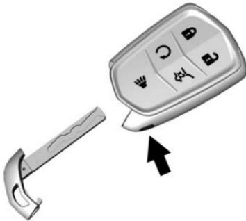
Pour la retirer, presser le bouton situé en bas de l'émetteur et retirer la clé. Ne jamais pas extraire la clé sans appuyer sur le bouton.
