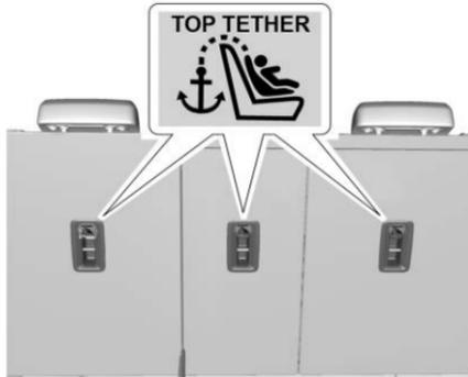
Les ancrages de sangle supérieure sont situés sur l'arrière des dossiers de siège de deuxième rangée et sont toujours alignés avec les sièges arrière et identifiés par le symbole
