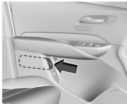
Glisser un parapluie compact ne dépassant pas 6 cm (2,36 po) de diamètre dans l'ouverture de la porte conducteur ou passager.
