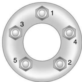
14. Serrer les écrous de roue fermement en croix, selon le schéma.
