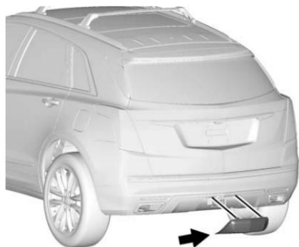
Pour déposer le couvercle d'attelage, si le véhicule en est équipé :
