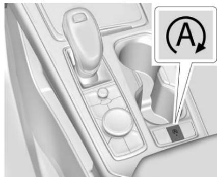
La fonction d'Arrêt/Démarrage automatique du moteur peut être activée et désactivée en appuyant sur (A). L'arrêt/démarrage automatique est activé à chaque démarrage.
