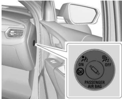
Ce commutateur doit uniquement être passé sur la position arrêt (OFF), si la personne se trouvant sur la position de passager avant extérieur appartient à une catégorie indiquée dans cette section :
