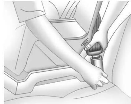
3. Enfoncer le verrou plat dans la serrure jusqu'à ce qu'elle se verrouille. Positionner le bouton de déblocage de la boucle à l'écart du système de sécurité pour enfant de manière à pouvoir détacher rapidement la ceinture en cas de besoin. Il ne doit pas y avoir de contact direct du système de sécurité pour enfant avec le bouton-poussoir.
