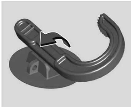
1. Insérer un côté du crochet du plancher de chargement dans le support.
