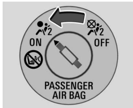
Pour réactiver l'airbag de passager avant extérieur, introduire la clé de contact dans l'interrupteur marche-arrêt d'airbag, l'enfoncer, et tourner le commutateur en position ON (activation).
