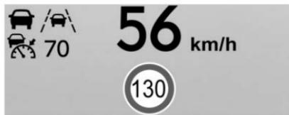
**Vue Vitesse** : Elle affiche la vitesse en format numérique en unités anglo-saxonnes ou métriques, la limite de vitesse et des indicateurs comme les véhicules qui précèdent, l'avertissement de sortie de voie/ l'assistance au maintien de trajectoire, le régulateur de vitesse adaptatif et la vitesse de consigne. Certaines informations apparaissent uniquement sur les véhicules qui ont ces fonctions et lorsqu'elles sont activées.
