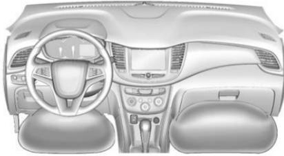
L'airbag de protection des genoux se trouve sous la colonne de direction. L'airbag de protection des genoux pour passager avant extérieur est sous la boîte à gants.
