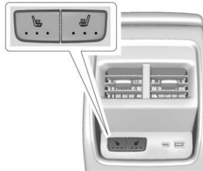
Selon l'équipement, les boutons du siège chauffant arrière se trouvent sur l'arrière de la console centrale.
