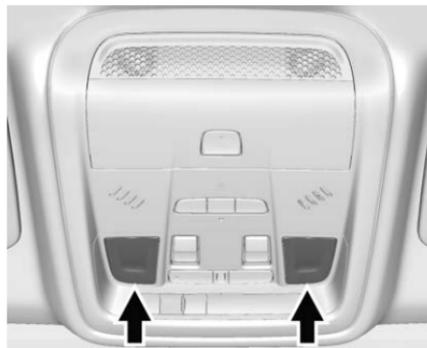
Appuyer sur les lentilles des lampes pour allumer ou éteindre les lampes de lecture avant.
