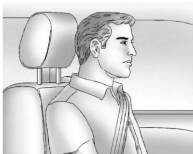
Régler l'appui-tête de sorte que sa partie supérieure arrive au niveau du haut de la tête de l'occupant. Cette position réduit les risques de blessure à la nuque lors d'un accident.
