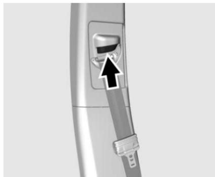
Maintenir enfoncé le bouton de déblocage tout en relevant ou en abaissant le dispositif de réglage de la hauteur jusqu'à la position souhaitée.
