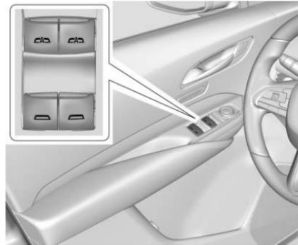
Les lève-vitres électriques fonctionnent lorsque le commutateur d'allumage est activé, sur le mode accessoires, ou quand le mode de prolongation de l'alimentation des accessoires (RAP) est activé. Se reporter à *Alimentation accessoires conservée* ⇨ 208.
