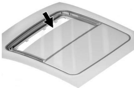
De la saleté et des débris peuvent s'accumuler sur le joint ou dans la glissière du toit ouvrant. Ceci peut causer un problème de fonctionnement ou de bruit du toit ouvrant. Le système d'écoulement d'eau peut également s'obstruer. Ouvrir périodiquement le toit ouvrant et retirer les obstacles ou les débris. Essuyer le joint du toit ouvrant et la zone d'étanchéité du toit avec un chiffon propre, du savon doux et de l'eau. Ne pas éliminer la graisse du toit ouvrant.
