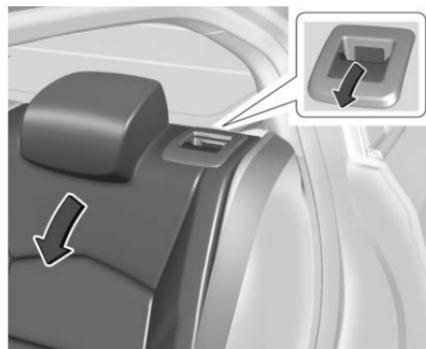
3. Tirer sur le levier placé sur le dessus du dossier pour le déverrouiller et rabattre le dossier vers l'avant.
