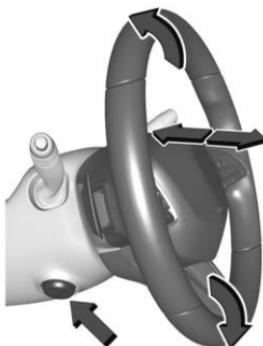
Appuyer sur la commande pour déplacer le volant de direction inclinable et télescopique vers le haut, le bas, l'avant ou l'arrière.
